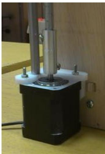
Slika 13. Prijenos rotacije step motora na navojnu šipku
