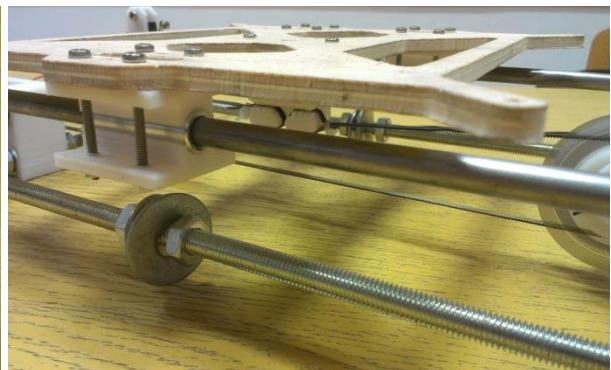
Slika 12. Klizna vodilica pričvršćena za podlogu
